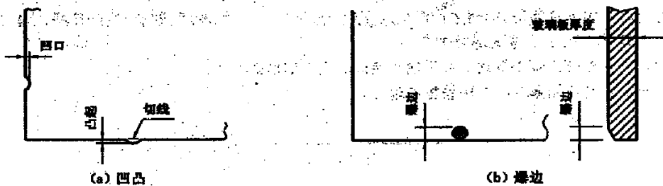
图 3 断面缺陷的测定
